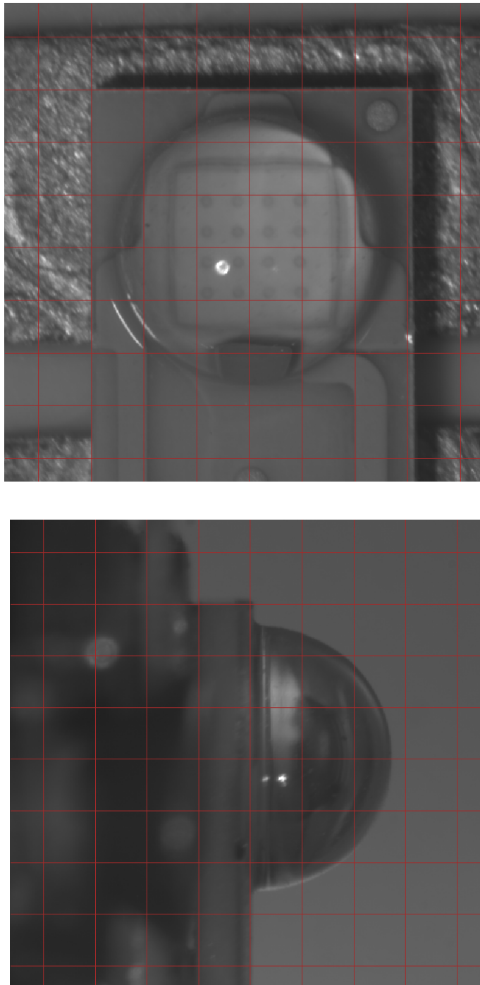
Figure 111 : Vues de face et de côté d'une LED blanc froid. L'échelle des photographies est donnée par la grille rouge dont chaque division mesure 0,5 mm de côté
