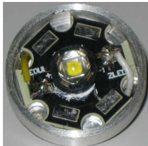
Figure 107 : Le composant à LED. Diamètre support 24 mm
