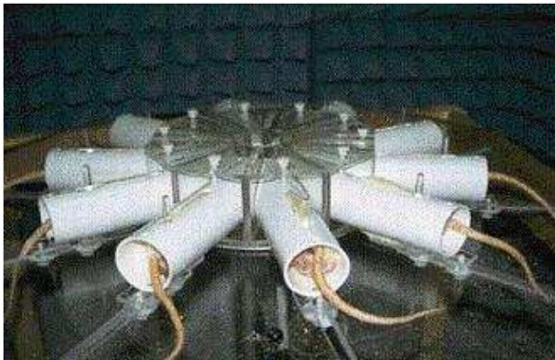
**Figure 30 : Carrousel pour l'exposition de 10 rats à 835 et 900 MHz**
